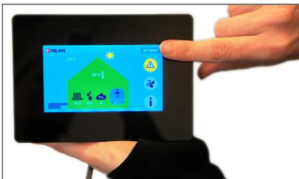
1. L'appareil est arrêté temporairement sur le panneau de contrôle, dans le menu « Options de filtre » sous « ventilation », avant d'ouvrir le couvercle.
