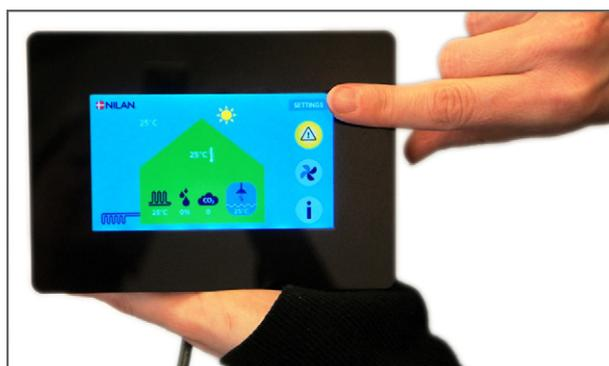
8. Réinitialiser l'alarme : Réinitialisez l'alarme sur le panneau de configuration dans le menu « Options de filtre » sous « ventilation ».
