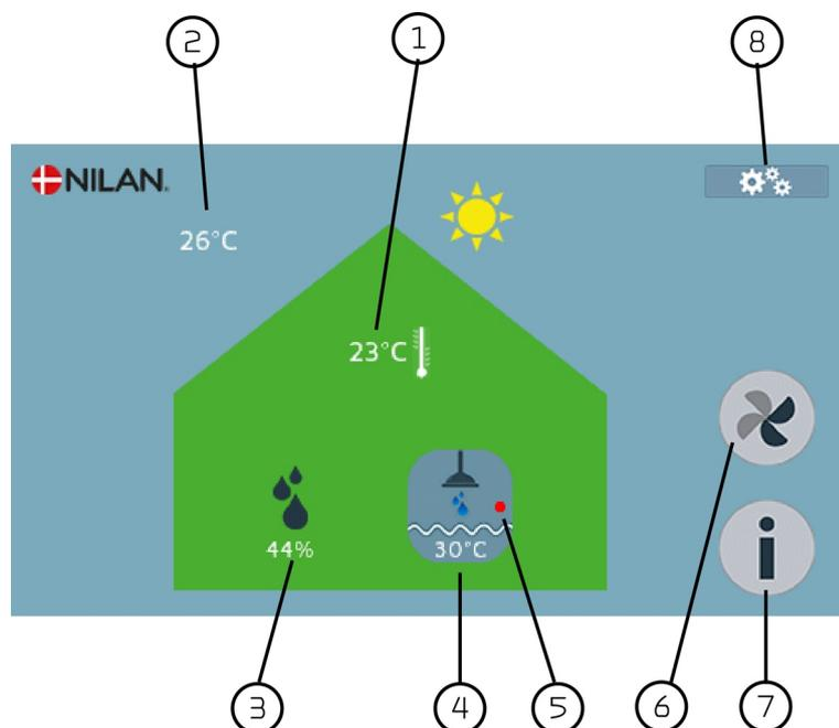
1. Indique la température ambiante actuelle dans la maison, mesurée via l'air d'extraction ou via une sonde de température externe.
