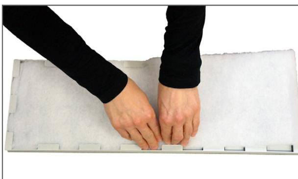
7. Le tapis filtrant est serré avec soin dans le cadre de filtre et bien poussé vers les côtés. Le filtre est réinstallé dans l'unité avec le tapis filtrant tourné vers le haut,
