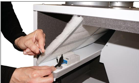
5. Le capteur CO<sub>2</sub> est monté dans l'étagère en acier en dessous du filtre d'air d'extraction avec des vis auto-foreuses (un assemblage de capteur de CO<sub>2</sub> est livré avec)...
