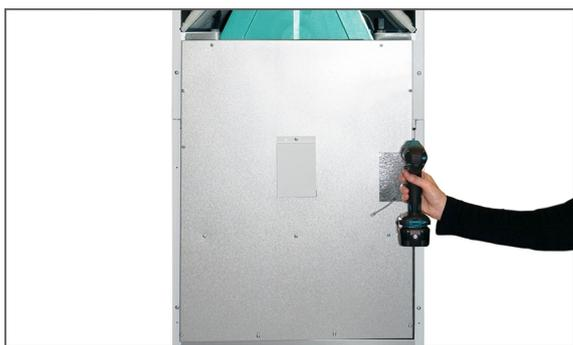
3. Les vis sont enlevées et la plaque de recouvrement est démontée.
