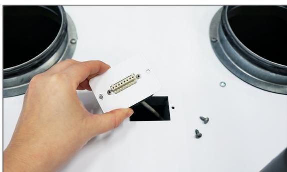
1. Le câble d'alimentation à 8 broches, qui est placé au haut de l'appareil, est démonté et poussé dans le trou.
