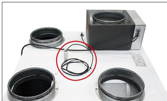
6. Le capteur T1 est tiré de la sortie à 8 pôles dans le conduit d'air extérieur (30 cm avant la surface de préchauffage).
