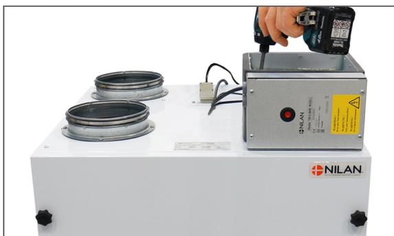
3. La surface de préchauffage est installée au niveau du raccord de la gaine d'air extérieur sur le dessus (standard) ou sur le côté de l'appareil (dans ce cas, le couvercle doit être déplacé pour couvrir le trou situé en haut).
