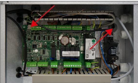
7. Le câble d'alimentation de la connexion USB est tiré du circuit imprimé et peut alors être tiré à travers la douille.
