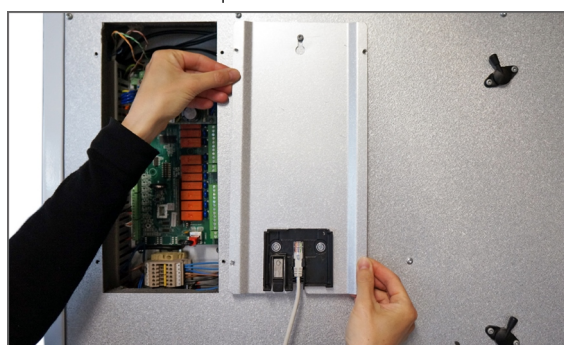
4. Dévissez la trappe et accrochez-la sur le côté.
