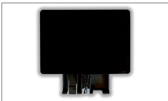
4. Emboîter l'écran tactile en place sur le support jusqu'à entendre un clic.
