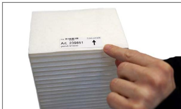
4. Le nouveau filtre à pollen doit être tourné avec la flèche du côté opposé des raccords de conduit
