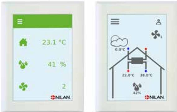
VPM 120-560 est contrôlée par le biais du panneau de commande à écran tactile HMI livré avec la centrale. Le contrôleur propose de nombreuses fonctions tel que la programmation hebdomadaire, le paramétrage de la périodicité de maintenance des filtres, le réglage de la vitesse de ventilation, la fonction bypass pour l'été (« free cooling » rafraîchissement libre), la configuration d'un chauffage additionnel, le journal des alarmes, etc.
