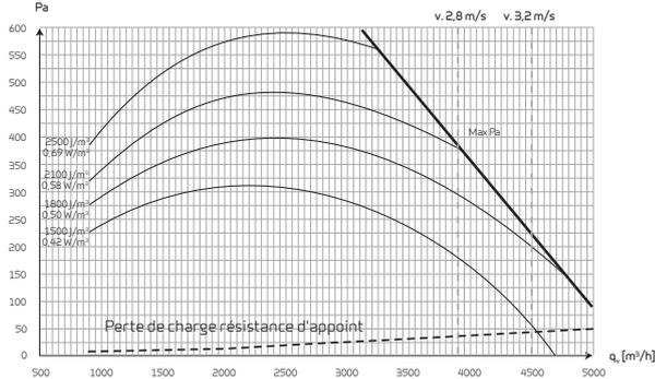
Capacité Max Pa d'une centrale, Pt,ext en fonction du débit  $q_v$ , pour valeurs SFP selon EN13053 pour une centrale avec des filtres ISO ePM10 >60% (M5) & ISO ePM1 50% (F7), sans accessoires. Le débit sur l'évaporateur est mesuré en mètre par seconde.
