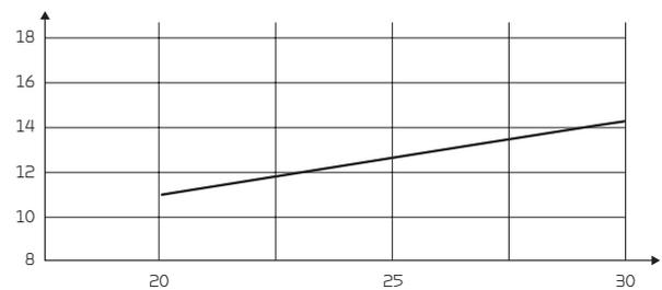
Température d'air soufflé [°C] en fonction de la température extérieur [°C] et le débit  $q_v$  3600 m³/h. Température d'air extrait = 25 °C
