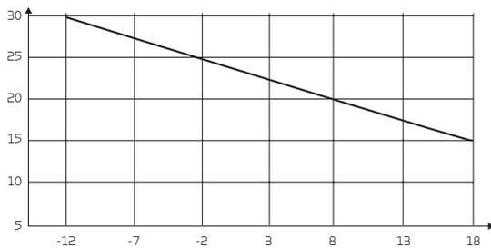
Puissance de transfert de chauffage  $Q_c$  [W] en fonction du débit  $q_v$  3600 m³/h et l'air extérieur [°C]. Selon EN 14511, air extrait = 20 °C.
